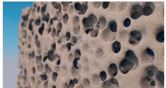
Die untereinander verbundenen Makroporen ermöglichen den Transport von Feuchtigkeit und darin gelöster Salze an die Bauteiloberfläche.
