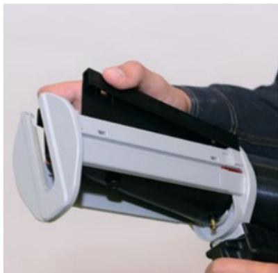
**1.** Kartuschenschale durch drücken der Clips lösen und herausnehmen.
