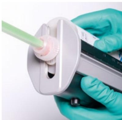
4. Kartusche in das MC-Fast-pack Power-Tool einsetzen.
