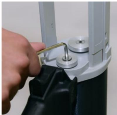
**2.** Untere Stößelschraube lösen und die Stößelscheibe entfernen.
