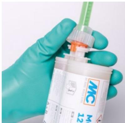
2. Statikmischer aufsetzen und mit Überwurfmutter fixieren.
