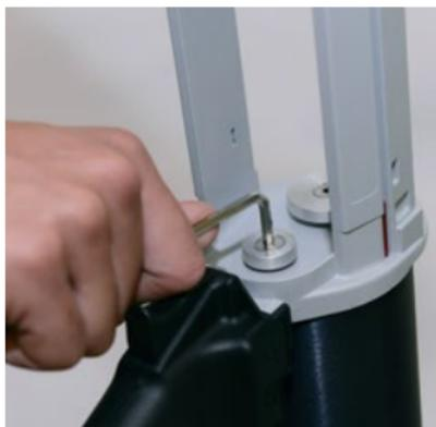
**3.** Entsprechend der gewählten Kartuschenschale die passende Stößelscheibe einsetzen und festschrauben.
